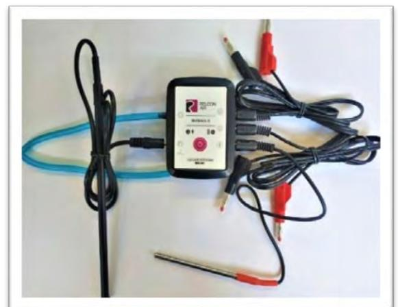
Рис. 9. Беспроводной мультидатчик Releon Air «Физика-5»
